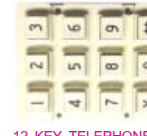
12 KEY TELEPHONE สามารถต่อเข้ากับขั้วต่อ KEY_IN1 ได้เช่นกัน โดยจะต้องใช้ ET-CONV KEY M1 สำหรับแปลง PORT เป็นแบบ BLOCK 10PIN เสียก่อน
