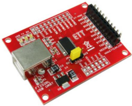
เป็นบอร์ดเปลี่ยนสัญญาณจาก PORT USB ของระบบคอมพิวเตอร์ให้เป็นสัญญาณการเชื่อมต่อแบบอนุกรม UART โดยให้ระดับสัญญาณเป็นแบบ TTL ทำให้เหมาะสมในการนำไปต่อโดยตรงเข้ากับไมโครคอนโทรลเลอร์ต่างๆ
