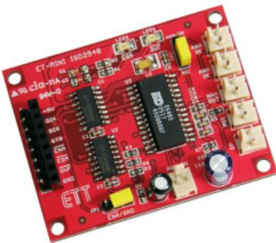
ET-MINI ISD2548 ... เป็นบอร์ด MINI ที่ใช้สำหรับบันทึกเสียง และเล่นกลับเสียงที่เราบันทึกไว้ได้เหมาะสมสำหรับงานที่ต้องใช้บันทึกเสียงที่มีความยาวไม่เกิน 48 นาที ความถี่ในการบันทึก และการเล่นกลับโดยใช้ต่อ กับ MCU ในแบบ SERIAL DATA (SPI) โดยผ่านทาง IC 74HC595 เพื่อลดจำนวนการใช้งานของขา I/O ของ MCU ที่จะนำมาต่อ
