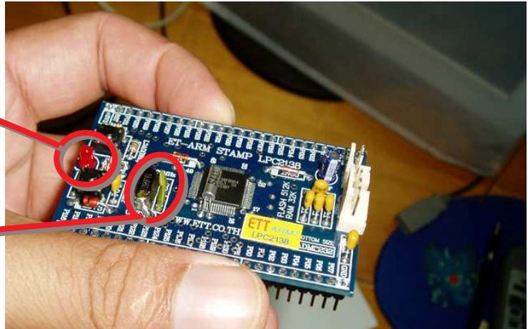
รูปที่ 6 คริสตัลและแอลอีดีแสดงสถานะการทำงาน
