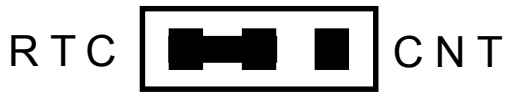
รูปแสดงการ Set Jumperเมื่อใช้งาน I 2 C เป็น RTC
