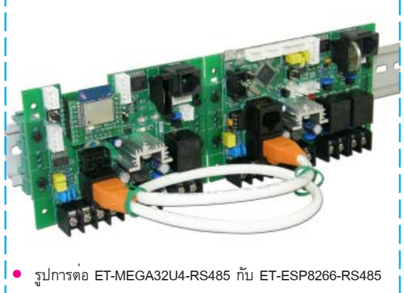
• รูปการต่อ ET-MEGA32U4-RS485 กับ ET-ESP8266-RS485 และ ET-SENSOR BME280, ET-SHT10 WATER PROOF
